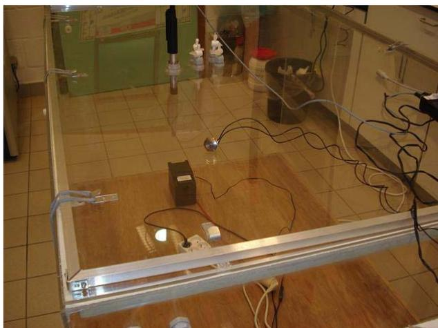
Photo 1 : Diffuseur installé dans l'enceinte
